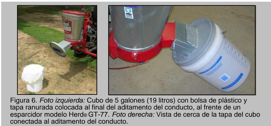
Figura 6. Foto izquierda: Cubo de 5 galones (19 litros) con bolsa de plástico y tapa ranurada colocada al final del aditamento del conducto, al frente de un esparcidor modelo Herd® GT-77. Foto derecha: Vista de cerca de la tapa del cubo conectada al aditamento del conducto.
