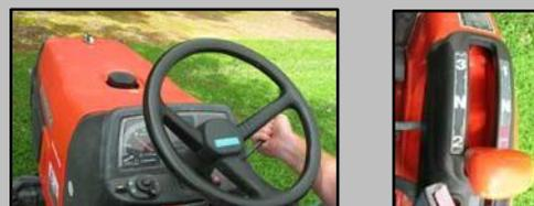
Figura 3. Foto izquierda: Ajuste manual de la palanca del acelerador en un tractor para aumentar o disminuir la velocidad del motor (RPM) que muestra el tacómetro. Foto derecha: La mayoría de los tractores cuentan con una amplia gama de opciones de engranajes.
