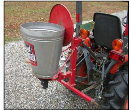
**Paso 2:** Mirar dentro del esparcidor, hacia el fondo, y ubicar el tornillo con el buje (ver flecha negra). Quitar el tornillo con un destornillador plano.
