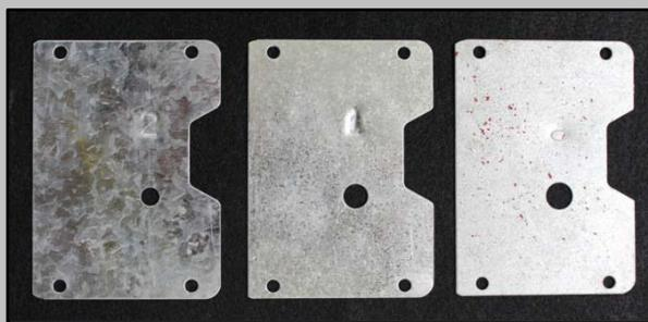
Figura 1. Placas de bloqueo de marca Herd®: #2 (imagen izquierda), #1 (imagen central) y #0 (imagen derecha). El agujero central es por donde cae el cebo del esparcidor. Los cuatro agujeros exteriores se usan para posicionar la placa de bloqueo en el esparcidor. La placa #2 tiene el agujero con el diámetro más pequeño (0.28 pulgadas o 7 milímetros), seguido por la #1 (0.35 pulgadas o 9 milímetros) y la #0 (0.39 pulgadas o 10 milímetros).
