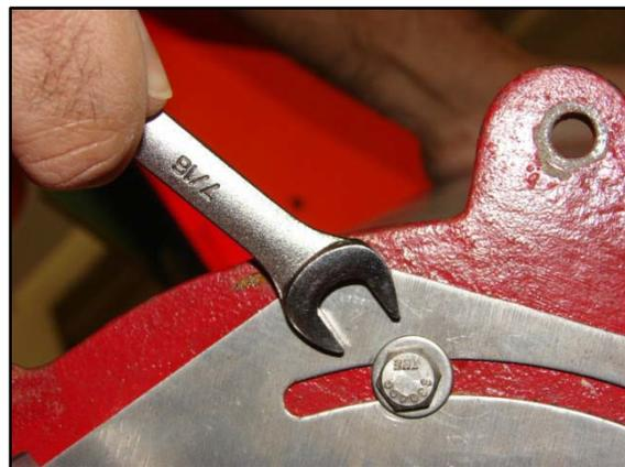
**Paso 4:** Deslizar la manija de la placa de pivote hasta la posición G (ver flechas amarillas). Esto creará un patrón de franja que cae cerca de 1 pie (30 centímetros) a la izquierda del esparcidor y 11 pies (3.4 metros) a la derecha. Luego apretar los pernos de la placa de pivote que se aflojaron en el paso 3.
